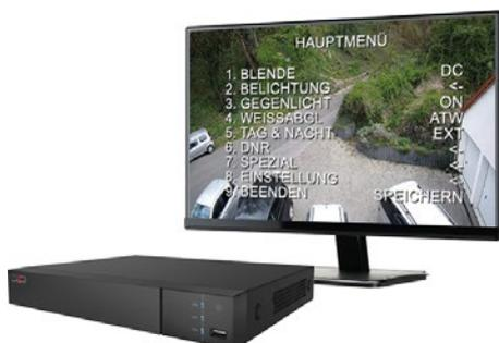
Der Recorder unterstützt UTC (Up The Coax). So können Sie in Verbindung mit einer kompatiblen Kamera das Bildschirmenü der Kamera auch über die Videoleitung konfigurieren. Es ist keine zusätzliche RS485 Verbindung erforderlich.
